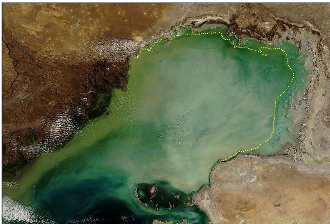
Рисунок 10 – Первое появление льда у восточного побережья Северного Каспия на снимке ИСЗ TERRA от 19 ноября (обработка ИНЭКО «Каспий»)
